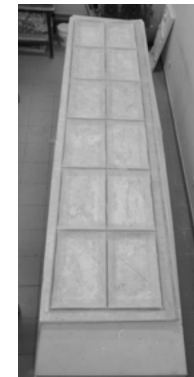
Konstrukcja odwrocia na bazie prętów z włókna szklanego wraz z laminatem, (fot. P. Krupa, 2017)
