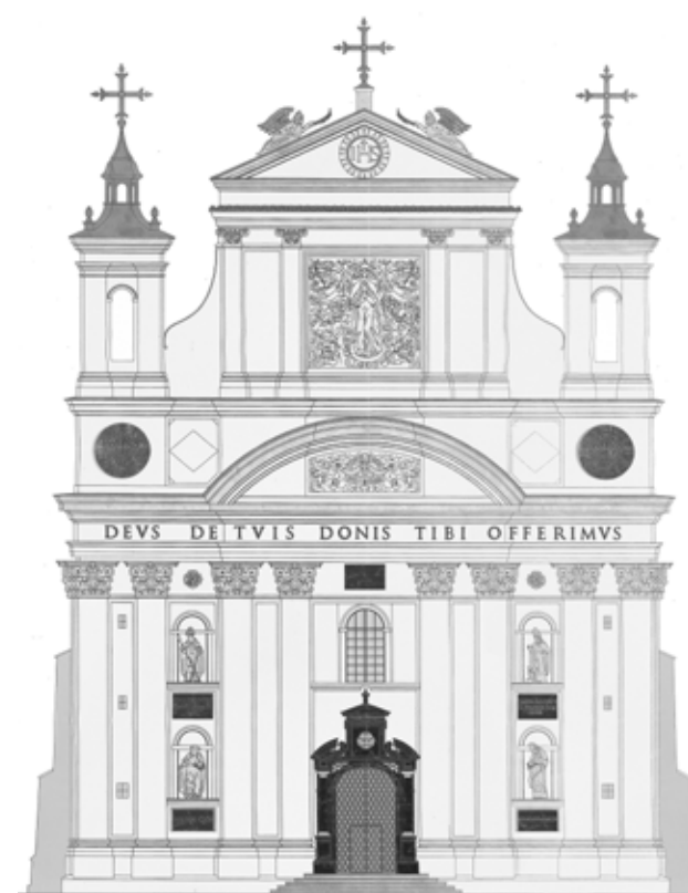
Propozycja kolorystyki elewacji pw. Świętej Trójcy w Olyce. Opracowanie nie uwzględnia rozwiązań kolorystycznych polichromowanych sztukaterii i posągów w niszach. Problematyka ta powinna zostać rozwiązana w trakcie trwania prac konserwatorskich – po odsłonięciu historycznych warstw malarskich i ocenie stanu ich zachowania pod kątem ekspozycji.
